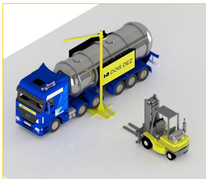
Só destrave a coluna com o Caminhão sobre o suporte
