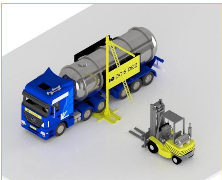
Após caminhão e a coluna na posição, pode-se posicionar a escada no suporte se necessário
