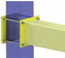
Fixação com Contrachapa
