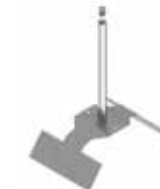
Poste Concreto Protendido Intermediário
